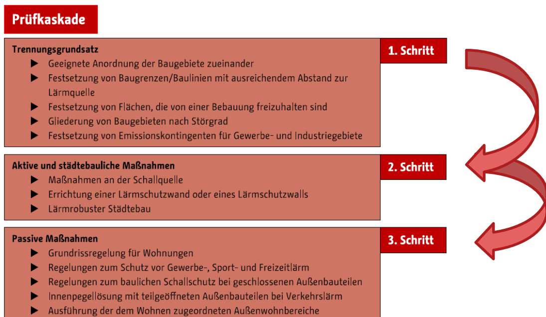
Abb. 8: Prüfkaskade Immissionsschutz Quelle: Lärmschutzleitfaden SenSW Berlin 2021. S. 65
