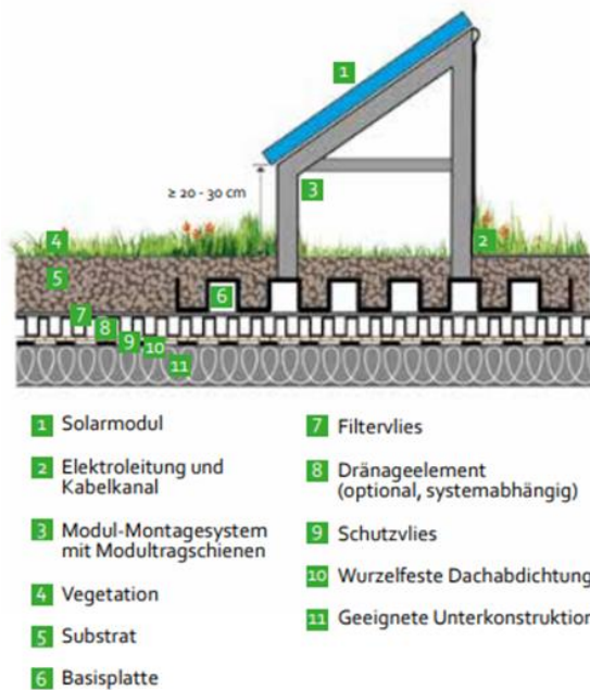
Abbildung 5: Schematische Darstellung eines auflastgehaltenen Solar-Gründach-Aufbaus (hersteller- und systembedingte Abweichungen möglich), Fachinformation „Solar-Gründach“, Bundesverband Gebäude-Grün e.V., 2020
