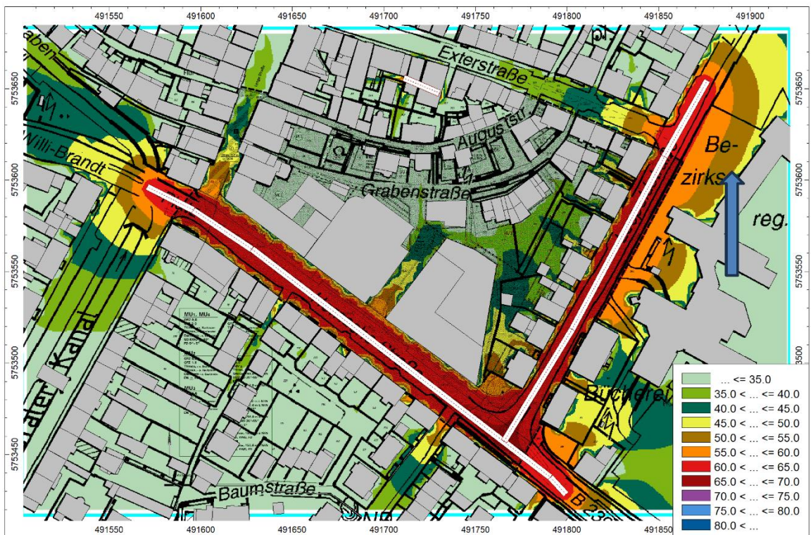
Abb. 6: Lärmpegelkarte Plangebiet, Beurteilungspegel Straßenverkehr – Nacht, TÜV NORD Umweltschutz GmbH & Co. KG (2025): Schalltechnische Untersuchung – Bebauungsplan Nr. 01-30/25 I Hornsches Tor I st der Stadt Detmold, 07.02.2025, Essen
