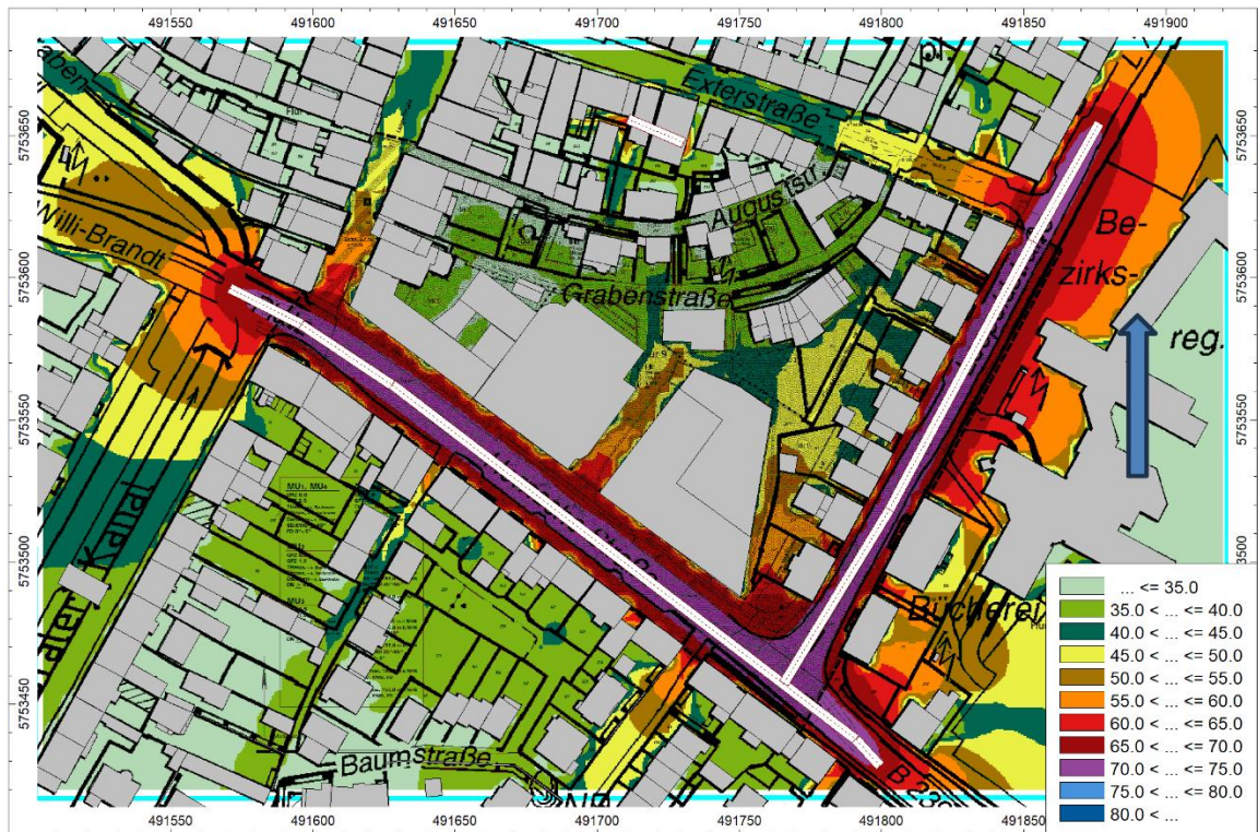
Abb. 5: Lärmpegelkarte Plangebiet, Beurteilungspegel Straßenverkehr – Tag, TÜV NORD Umweltschutz GmbH & Co. KG (2025): Schalltechnische Untersuchung – Bebauungsplan Nr. 01-30/25 I Hornsches Tor I st der Stadt Detmold, 07.02.2025, Essen
